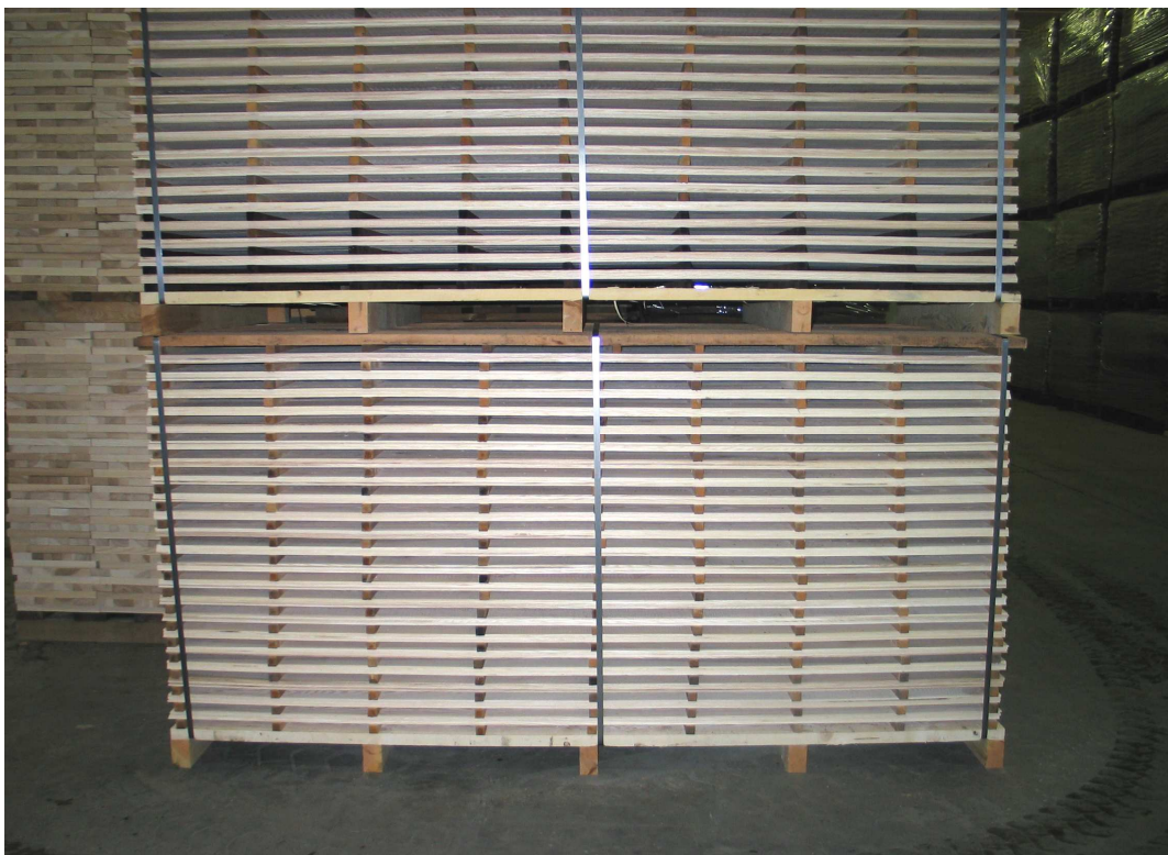
Abbildung 3.1: Stapelung von Schnittholz, Decklamellen und Landhausdielen. RICHTIG
