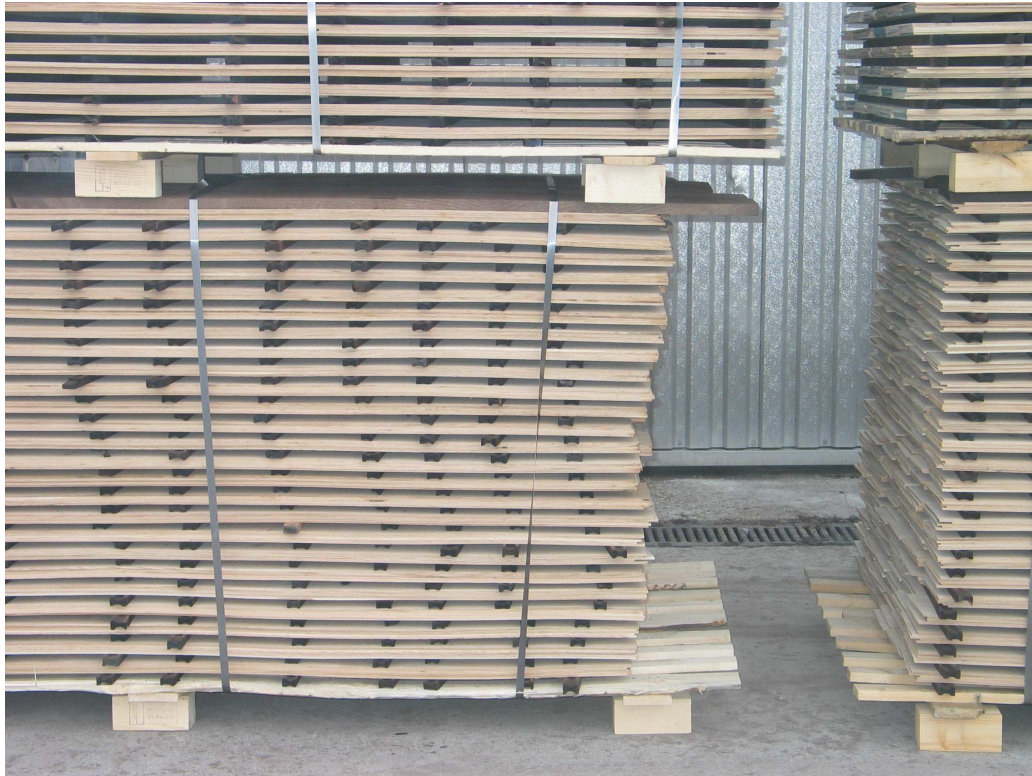
Abbildung 3.2: Stapelung FALSCH - Bei dieser Manipulation ist ein großer Schaden zu erwarten.
