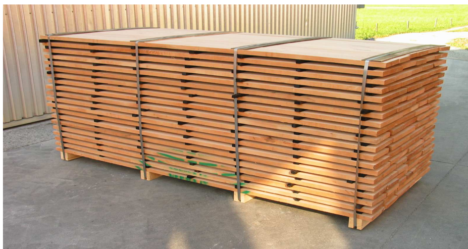
Abbildung 1: Optimal manipuliertes Schnittholzpaket für die Thermobehandlung.
