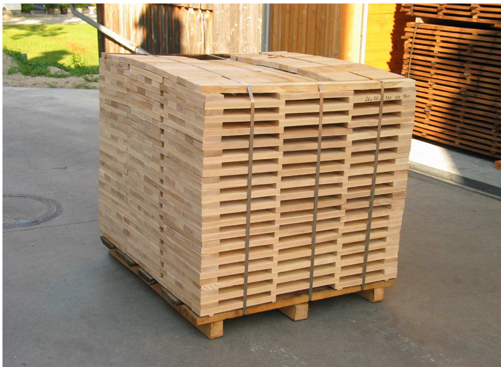
Abbildung 2: Optimale Stapelung von Friesen zur Thermobehandlung.
